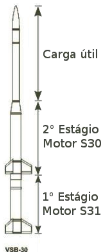
Diagrama do foguete VSB-30. Disponível em: https://pt.m.wikipedia.org/wiki/Ficheiro:Diagrama_VSB-30.svg Acesso em: 08/07/2020
